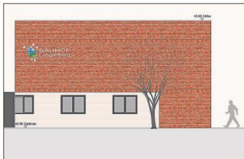
Das Kopfgebäude soll eine gestaltete Klinkerfassade bekommen. Der Eingangsbereich ist über ein Eckfenster gut einsehbar.
